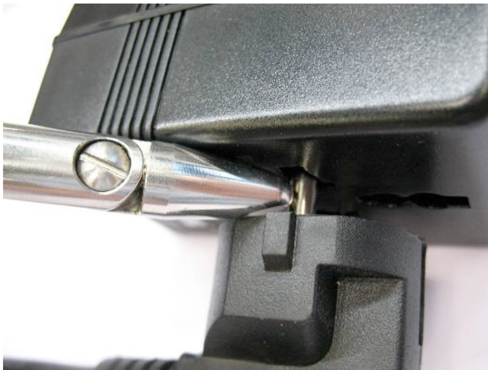
Figur 6 - Spänningsförande stift åtkomligt
