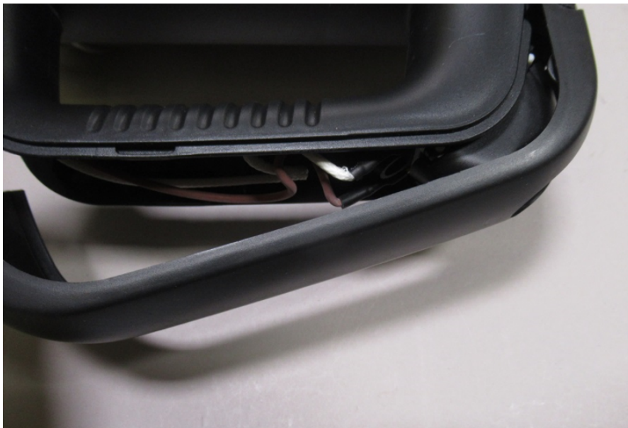
Figur 3 - Höljet lossnar för lätt
