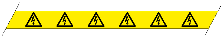
V2 Varningsband anbringas runt stolpe för högspänningsledning. Symbol och bård utförs på gul bakgrund. Bandet ska vara ca 100 mm brett.
