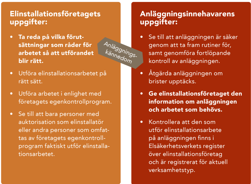
Figur 16. Anläggningsinnehavarens och elinstallationsföretagets respektive skyldigheter.
