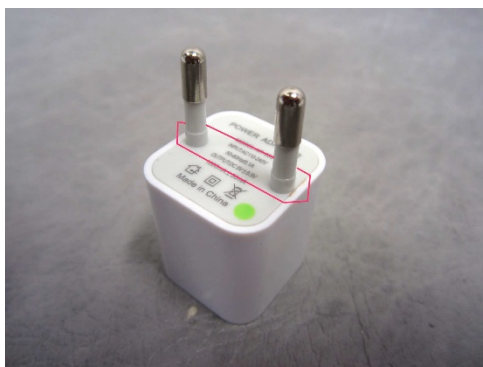
Figur 4: Fel form på stickproppsdel
